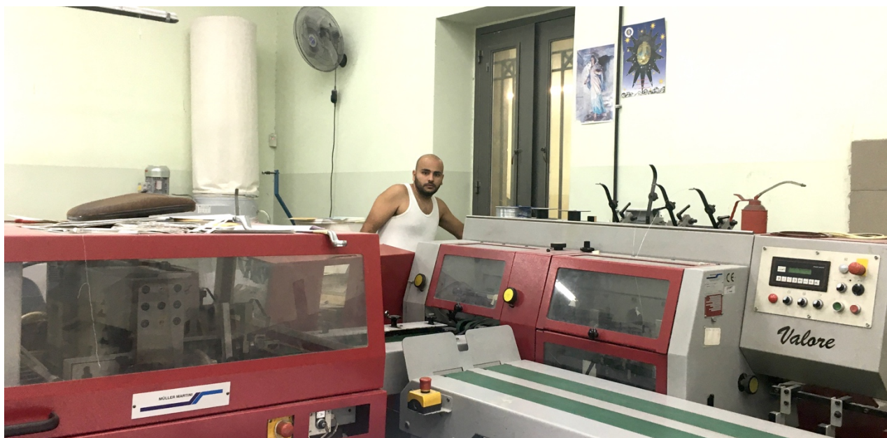
Figure 32.1 e 32.2 Betfage, nuova sede della Franciscan Press . Due giovani tipografi sovrintendono i lavori. Sopra, una macchina da taglio per libri trilaterale (in grado quindi di rifilare contemporaneamente su tre lati); sotto, un'altra taglierina di ultimissima generazione, in primo piano, alcune copie appena stampate di libretti per pellegrini asiatici.
