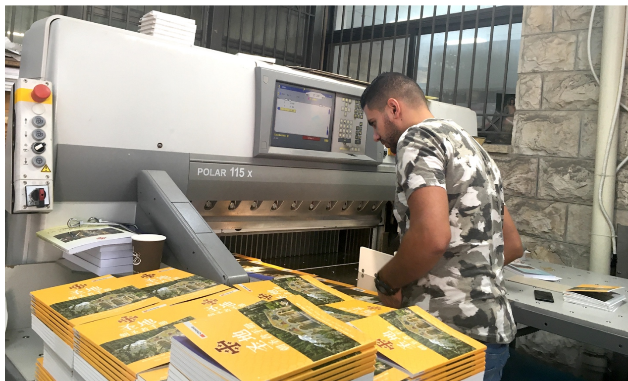
Figure 32.1 e 32.2 Betfage, nuova sede della Franciscan Press . Due giovani tipografi sovrintendono i lavori. Sopra, una macchina da taglio per libri trilaterale (in grado quindi di rifilare contemporaneamente su tre lati); sotto, un'altra taglierina di ultimissima generazione, in primo piano, alcune copie appena stampate di libretti per pellegrini asiatici.
