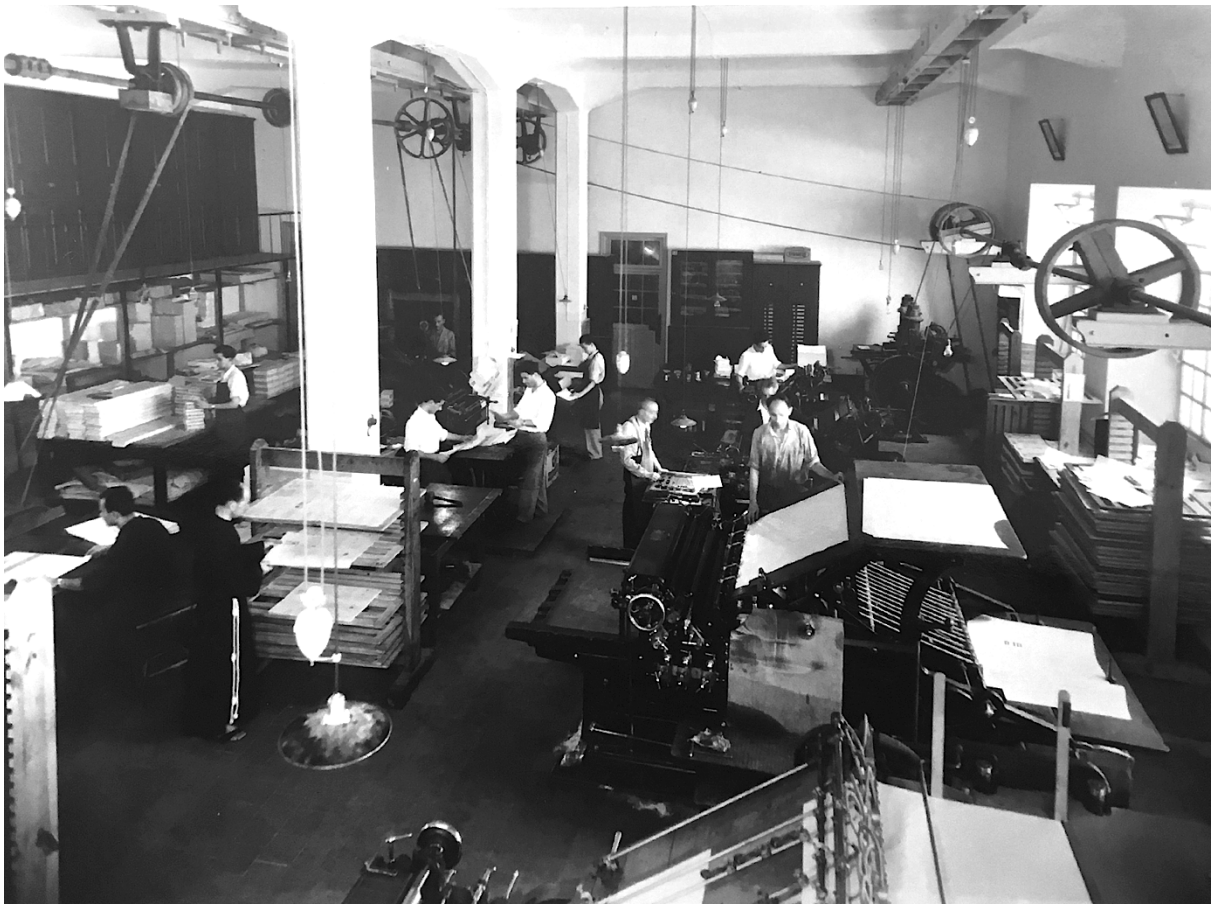
Figura 4 Una foto della seconda metà del XX secolo dell'officina tipografica di S. Salvatore. Nella parte alta dell'immagine è ben visibile il sistema di alimentazione delle macchine da stampa a mezzo di cinghie, carrucole e alberi di trasmissione (a loro volta alimentati da un grosso motore posizionato in una stanza diversa del Convento, cfr. Figure 3.1 e 3.2), da ASCTS, Fondo fotografico p. Faccio, Album 3-4.
