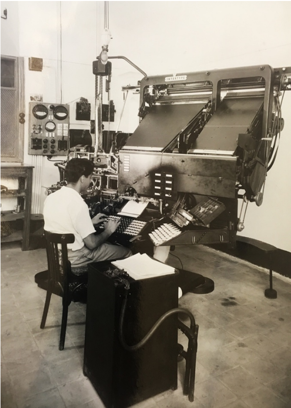
Figure 26.1 e 26.2 Intertypisti nella Franciscan Press , circa 1960, al lavoro mentre battevano sulla tastiera della macchina fonditrice-compositrice il testo da riprodurre; da ASCTS, Fondo fotografico p. Faccio, album 3-4.
