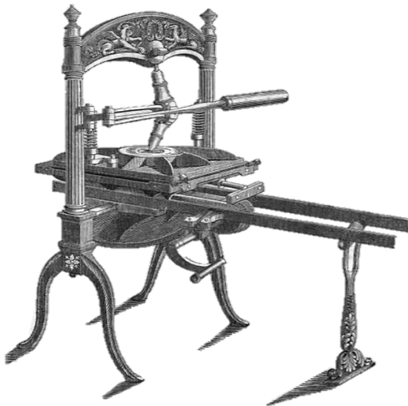
Figura 3 Una Hagarpresse ritratta in «Journal für Buchdruckerkunst, Schriftgießerei und verwandte Fächer», 1836, n. 2, colonne 41-2. È stata la prima pressa da stampa in uso presso la Franciscan Printing Press (cfr. nota 83).
