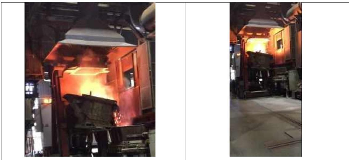
“chiaramente”, almeno per il regista, il contatto tra scorificante e metallo liquido genera una reazione che produce vapore e polvere, e “chiaramente” (questa volta non lo dice), quella macchina sembra essere pensata, anche, per limitare il quantitativo di polvere nell’ambiente di lavoro. La tecnologia è lì anche per quello, per rendere l’ambiente di lavoro più ospitale.
