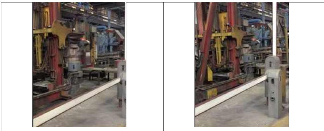
Nel momento in cui le sbarre vengono alzate, l'impianto si ferma automaticamente, così che nessuno possa accedere mentre le siviere sono in movimento. Anche qui il regista si focalizza sull'aspetto delle barriere, un aspetto che per lui sembra essere importante per comprendere il funzionamento della tecnologia.
