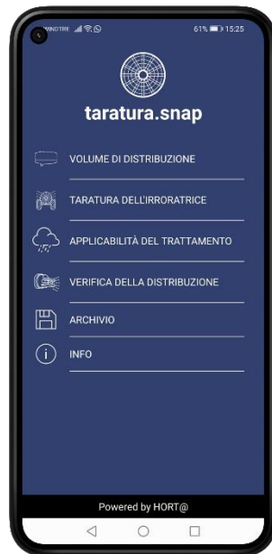
Figura 3: Schermata iniziale del menu taratura.snap su smartphone dove sono visualizzati i diversi moduli indipendenti per il calcolo dei parametri d'applicazione (volume di distribuzione e taratura dell'irroratrice), il modulo per la valutazione dell'applicabilità del trattamento, la verifica della distribuzione, l'archivio e la funzione Info.
